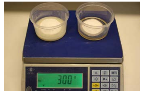
Abb. 3 : 180 Gramm Füllstoff (300 %), verteilt über die beiden Komponenten. 300 Gramm Gesamtmischung (1 : 1 : 3).
