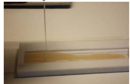
Abb. 5 : Gießen Sie mit dünnem Strahl und lassen Sie das PU voraus laufen.
