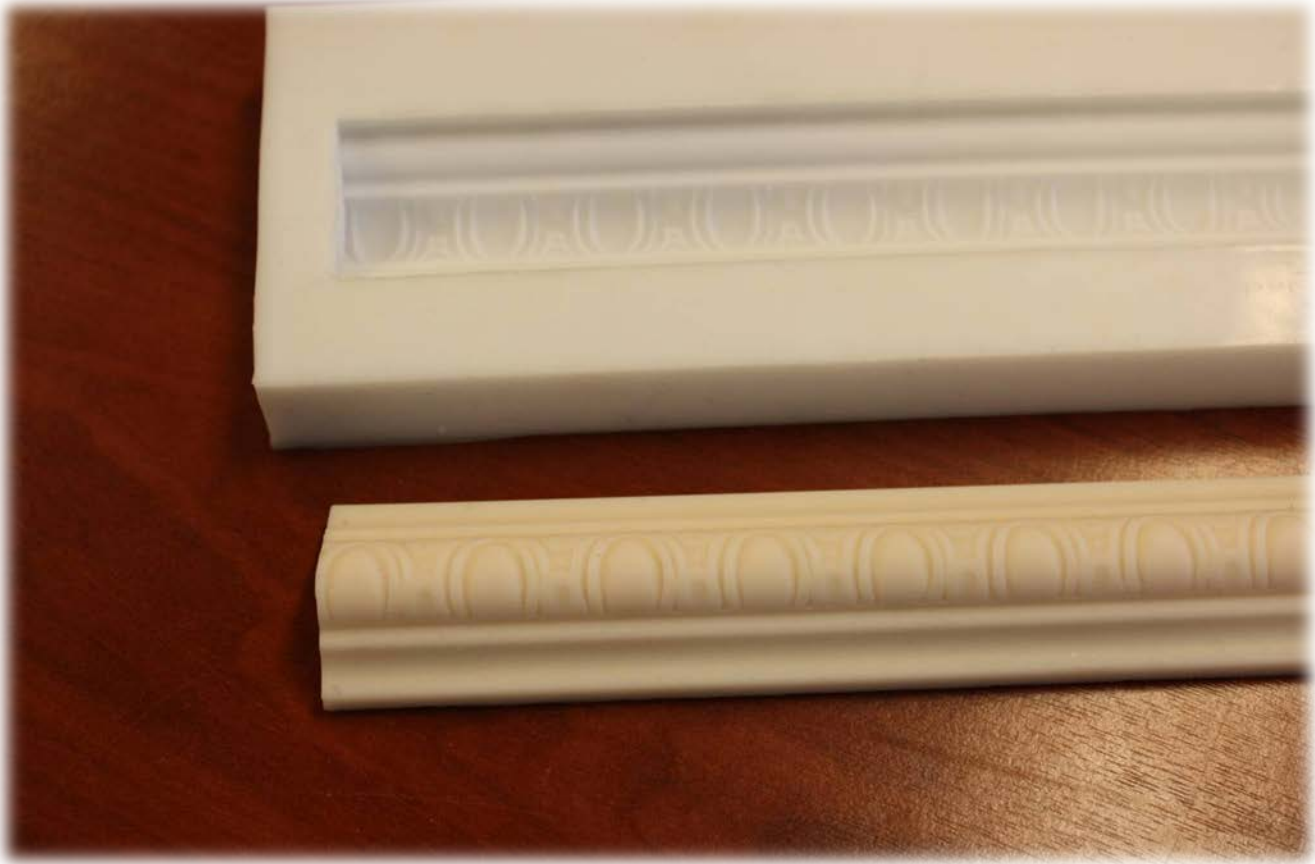
Abb. 6: Endergebnis, entformt, nach 60 Minuten.
