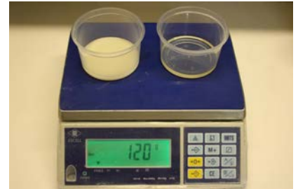
Abb. 2 : Zwei Mischbecher, 60 Gramm A-Komp. und 60 Gramm B-Komp. (1 : 1)
