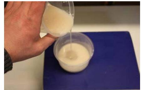
Abb. 4 : Wenn die beiden Komponenten gut mit dem Füllstoff gemischt wurden, werden sie miteinander gemischt.
